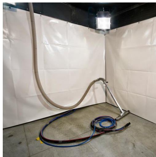
Pneumatické odsávání hubicí
