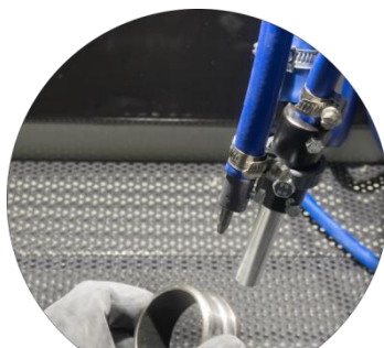
Teleskopický držák trysky pro usnadnění tryskání malých předmětů
