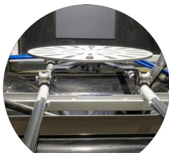
Stacionární nebo vyjížděcí točna pro tryskání hmotných dílů
