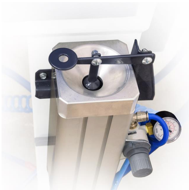
Mikrotryskač se plní vždy novým nebo tříděným tryskacím prostředkem. Na obrázku je páka plnění. Po jejím stisknutí se vsype dávka abraziva do zásobníku.
