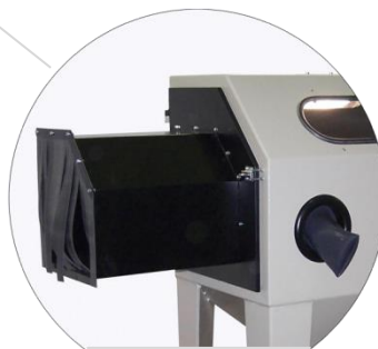
Protahovací otvory ve dveřích pro tryskání tyčového materiálu
