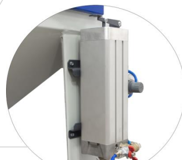
Mikrotryskač pro intenzivní bodové tryskání
