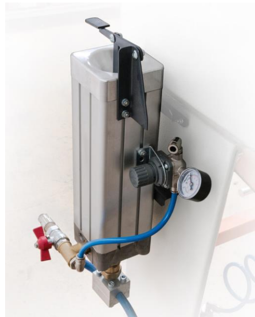
Mikrotryskač slouží často jako doplňkové tlakové tryskací zařízení injektorových boxů. Připevňuje se na bok nebo přední nohu kabiny.
