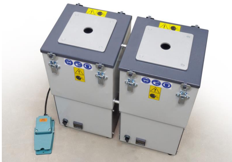
Značkovací tryskač ZTZ-2 Double. Zdvojení umožňuje pracovat „obouruč“ a výrazně zvýšit kapacitu.
