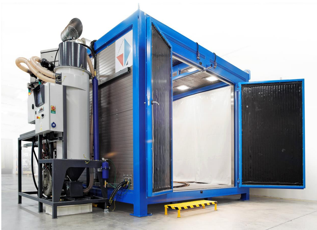
Komora 3 x 3 m s podlahovým odsáváním a zdvojenou jednotkou vnějšího oběhu. Umožňuje rychlé střídání abraziva pákovým přepínačem (např. mezi korundem a skleněnou balotinou). Každý tryskací materiál má vlastní čistič a zásobník.
