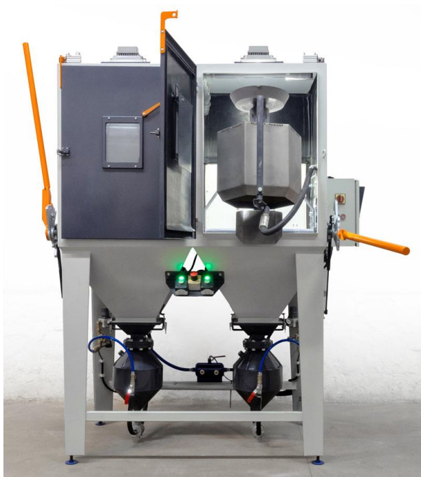
Dvojhubnový tryskač s ručním vyklápěním pákou
